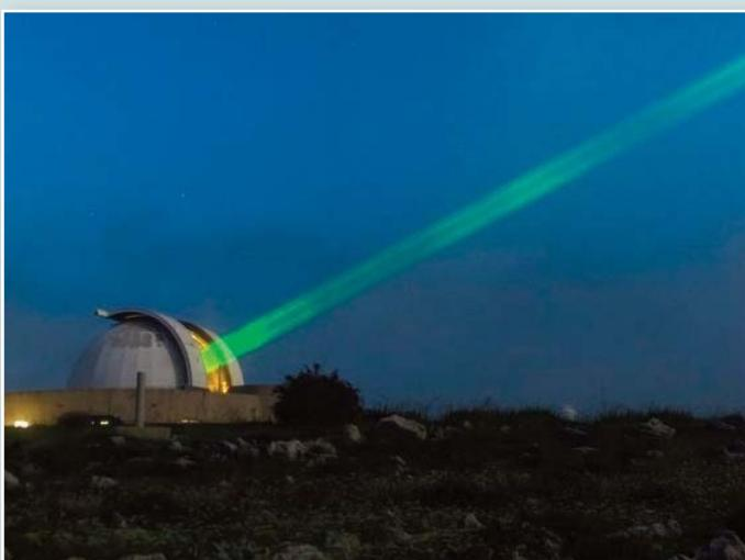
minarea cu o precizie foarte mare a poziției unei ținte. În cadrul programului Apollo-11 s-a reușit determinarea distanței Pământ-Lună. Locatoarele optice folosesc ca surse în special laserii și acestea se bazează pe utilizarea regiunii optice a spectrului undelor electromagnetice. Locatoarele laser sunt capabile să localizeze avioane, tancuri și submarine. Iluminatoarele și sistemele de ghidare a proiectilelor sunt utilizate în cazul distanțelor scurte.
